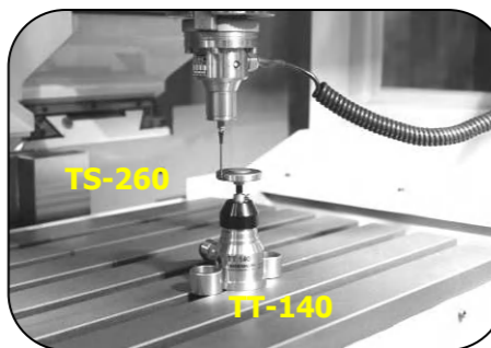
MESSTASTER TS-260: Messtaster für Werkstück-Vermessungen TS-640: Infrarot-Messtaster für Werkstückvermessungen TT-140: Sonde für Werkzeugvermessungen
