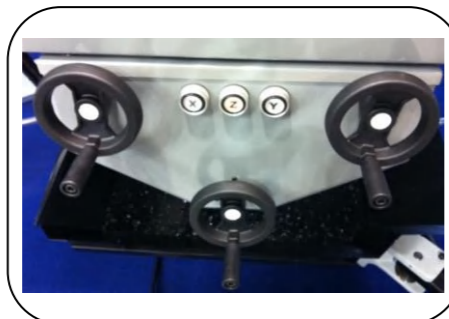
ELEKTRONISCHE HANDRÄDER 3 Handräder für die X-, Y- und Z-Achse elektronisch gesteuert (vorne am Tisch montiert). Diese Option ersetzt das elektr. Handrad HR 510
