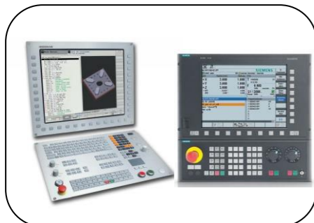
STEUERUNG HEIDENHAIN TNC 640 ODER SIEMENS 840 D Steuerungen zum High-End Fräsen und Drehen im 5-Achs-Bereich.
